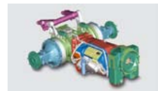
Przekładnia jest sterowana elektronicznie i wykorzystuje komponenty mechaniczne oraz hydrostatyczne zapewniające bezstopniowy zakres prędkości.
